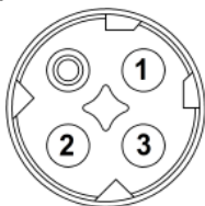
Вывод1: питание (+) Вывод2: питание (-) Вывод3: выход 0,5-4,5В
